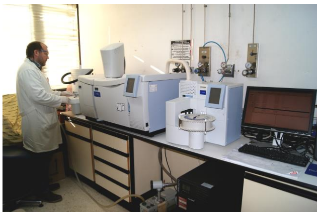
Técnico de AIDIMA analizando n-butanol por HS-GC
