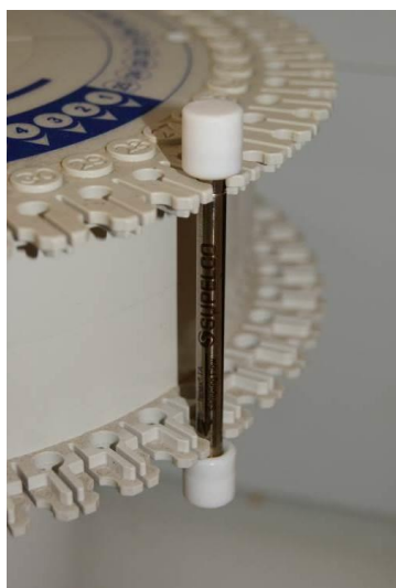
Tubos adsorbentes de Tenax TA® dispuestos para su análisis por espectrometría de masas.
