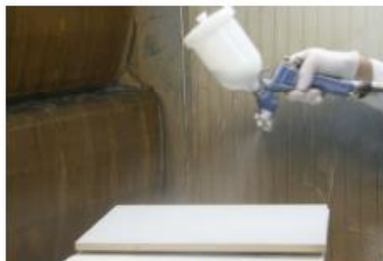
PROCESO DE PINTADO DE TABLERO DERIVADO DE LA MADERA MEDIANTE EL USO DE PINTURAS EN BASE AGUA EN CUMPLIMIENTO DE LA DIRECTIVA 2004/42/CE
