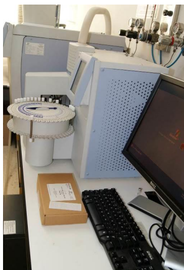
Tubos adsorbentes de Tenax TA® dispuestos para su análisis por espectrometría de masas.
